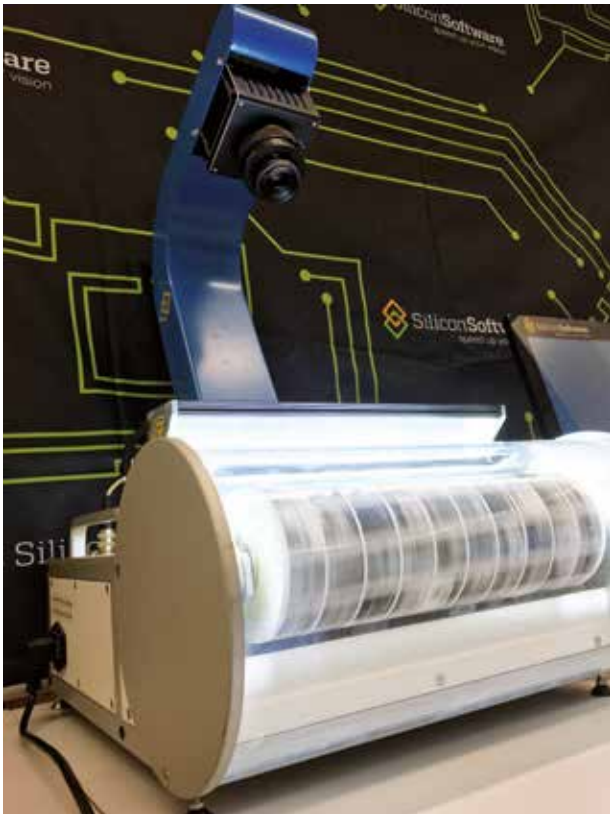
Auf einem FPGA laufende Deep Learning Anwendung (Fehlerdetektion auf metallischen Oberflächen) mit einer hohen Datenrate von etwa 200 MByte/s
